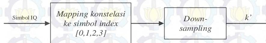
Gambar 3.20 Blok demodulasi QPSK
