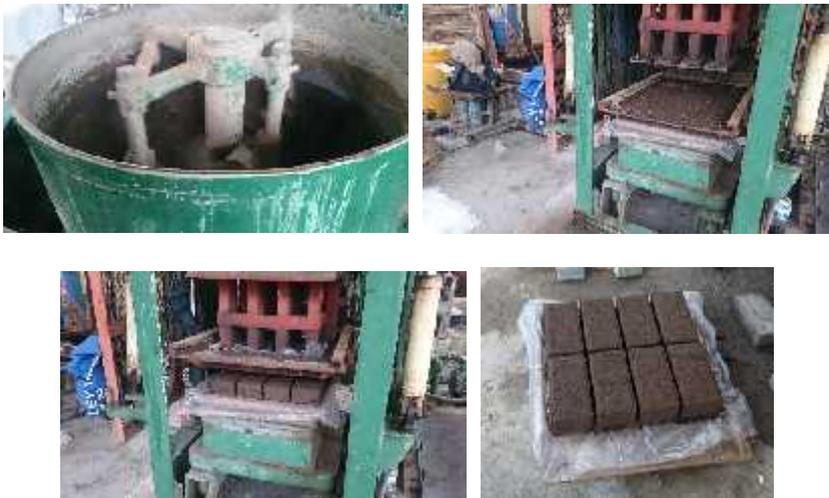
**Gambar 4.25** Hasil proses pembuatan paving geopolimer dengan cara masinal yaitu memakai mesin press hidrolis
