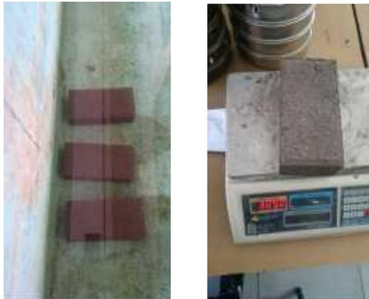
**Gambar 4.35** Uji Penyerapan Air *Paving* Geopolimer di Lab. Beton dan Bahan Bangunan S1 Teknik Sipil-ITS.
