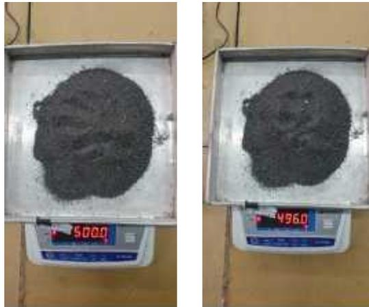
**Gambar 4.7** Proses Uji Pencucian Pasir terhadap Lumpur
