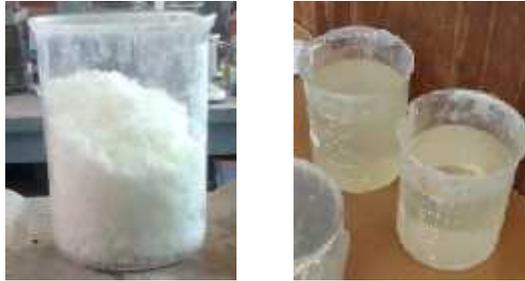
**Gambar 3.7** NaOH flakes dan larutan NaOH 8M
