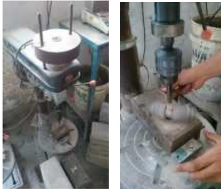
**Gambar 3.13** Alat untuk tes ketahanan aus di Laboratorium Beton dan Bahan Bangunan D3 Teknik Sipil-ITS
