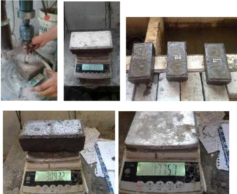
**Gambar 4.33** Uji Ketahanan Aus Paving Geopolimer di Lab. Beton dan Bahan Bangunan D3 Teknik Sipil-ITS.
