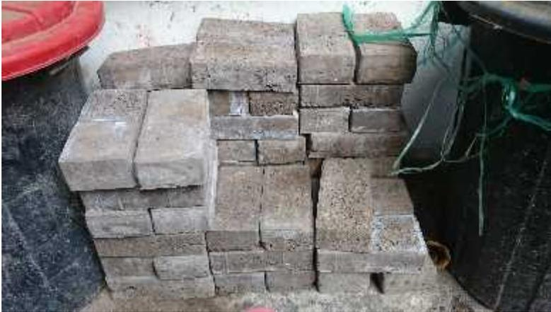
**Gambar 3.14** Hasil *paving* geopolimer yang sudah dilakukan di Lab Beton ITS dengan tebal 6 cm sampai saat ini dengan komposisi *bottom ash* 0% hingga mencapai K-500.
