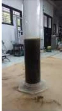
**Gambar 4.12** Hasil Uji Pencucian Pasir terhadap Lumpur
