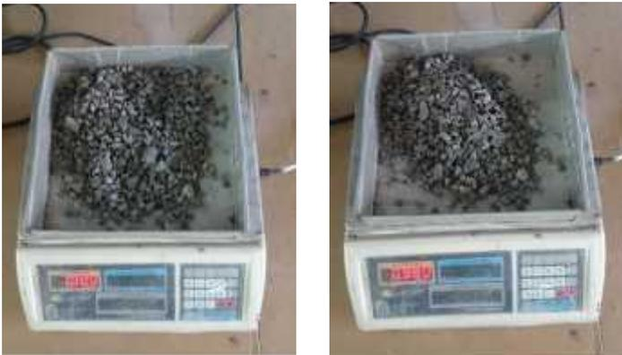
**Gambar 4.17** Proses Uji Pencucian batu pecah terhadap Lumpur
