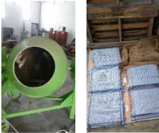
**Gambar 4.24** Hasil proses pembuatan paving geopolimer dengan cara manual yaitu memakai alat cetak manual
