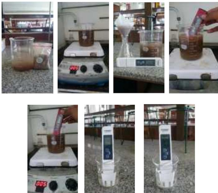
**Gambar 4.41** Proses pengujian pH dan TDS yang dilakukan di Lab Kimia ITS Surabaya.
