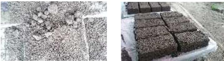
**Gambar 4.31** Kegagalan campuran *jobmix* saat pengecoran *paving* geopolimer dengan alat press masinal.
