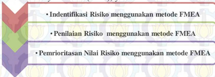
Gambar 3.2.3.2.1. Tahapan penilaian risiko menggunakan metode FMEA (Sumber: FMEA)
