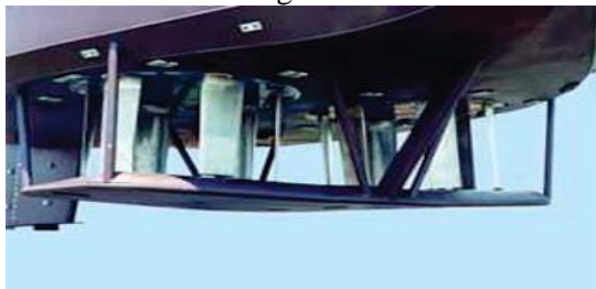
Gambar 2.3.7 Voith Sneider Propeller
