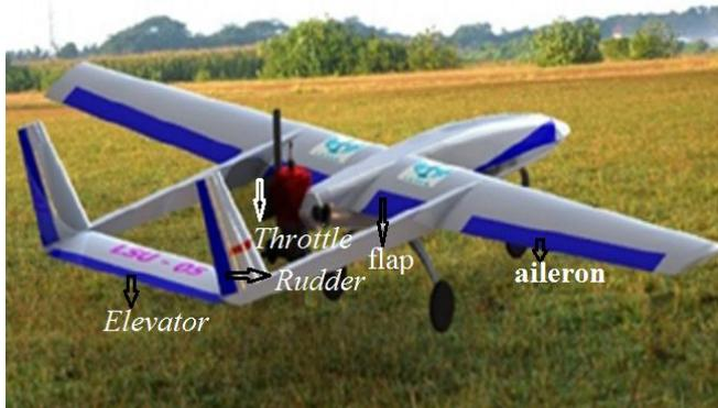
**Gambar 2.2 Sistem Kontrol Permukaan Pesawat pada LSU-05**
