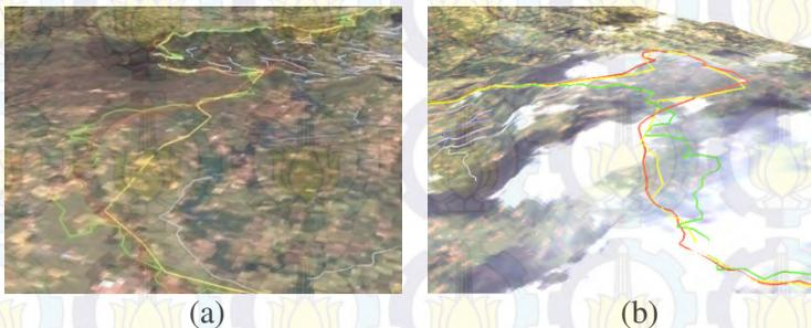
Gambar 4.8 Perbandingan batas DAS dalam model 3D (a) Menunjukkan perbedaan batas DAS pada bagian Hilir, dan (b) menunjukkan perbedaan batas DAS pada daerah Hulu
