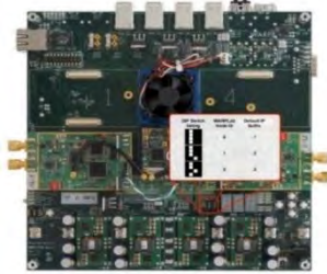
Gambar 3-26. Konfigurasi dipswitch Untuk Mengatur IP pada WARP
