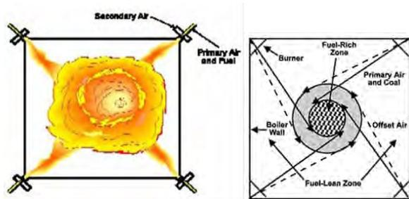
Gambar 2.8 Ilustrasi proses pembakaran pada tangentially-fired boiler
