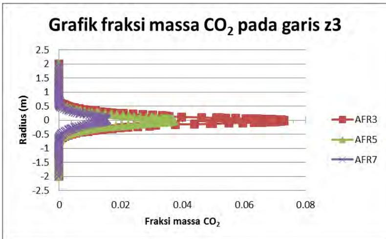
Gambar 4.13. Grafik *mass fraction* CO<sub>2</sub> pada garis z3 terhadap radius open chamber.
