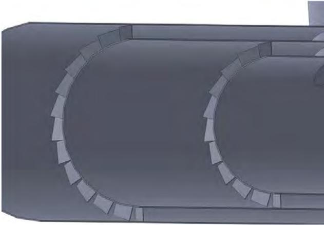
Gambar 1.3. gambar fin swirl air pada burner
