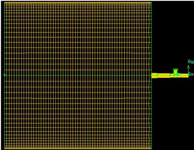
Gambar 3.5. Hasil meshing obyek keseluruhan tampak samping
