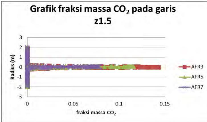
Gambar 4.10. Grafik *mass fraction* CO<sub>2</sub> pada garis z1.5 terhadap radius open chamber.
