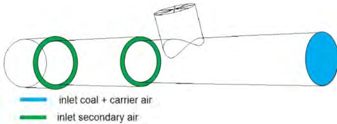
Gambar 3.8 gambar pemodelan geometri burner dalam simulasi
