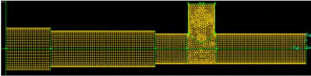
Gambar 3.4. Hasil meshing pada bagian burner tampak samping
