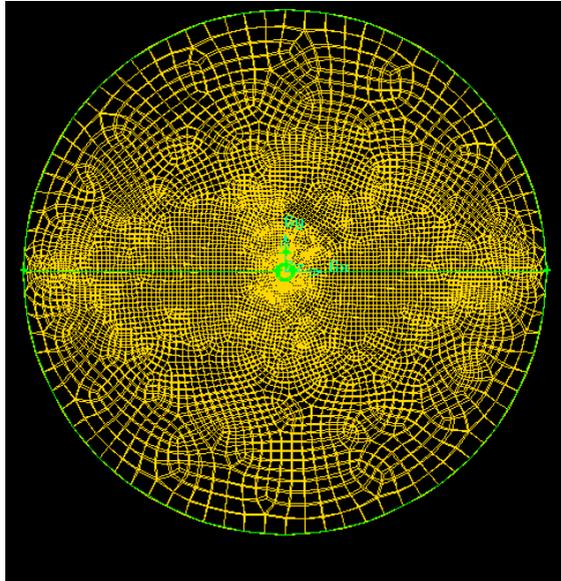
Gambar 3.6 Hasil meshing obyek open chamber tampak depan
