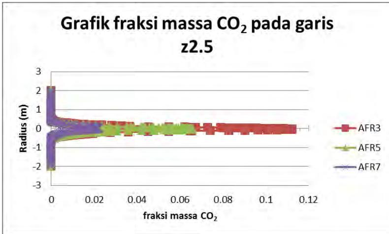
Gambar 4.12. Grafik *mass fraction* CO<sub>2</sub> pada garis z2.5 terhadap radius open chamber
