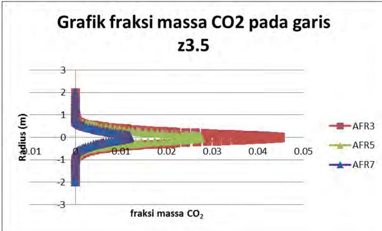
Gambar 4.14. Grafik *mass fraction* CO<sub>2</sub> pada garis z3.5 terhadap radius open chamber.
