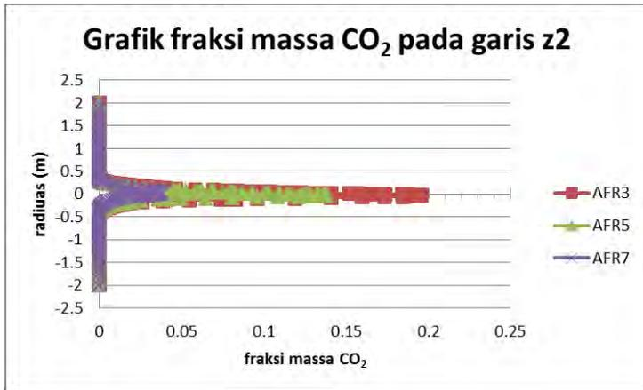
Gambar 4.11. Grafik *mass fraction* CO<sub>2</sub> pada garis z2 terhadap radius open chamber.
