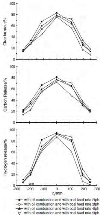
Gambar 2.7 kandungan carbon dan hydrogen dan unbrnt coal dari hasil dari pembakaran dengan variasi coal feed rate secara radial pada outlet burner
