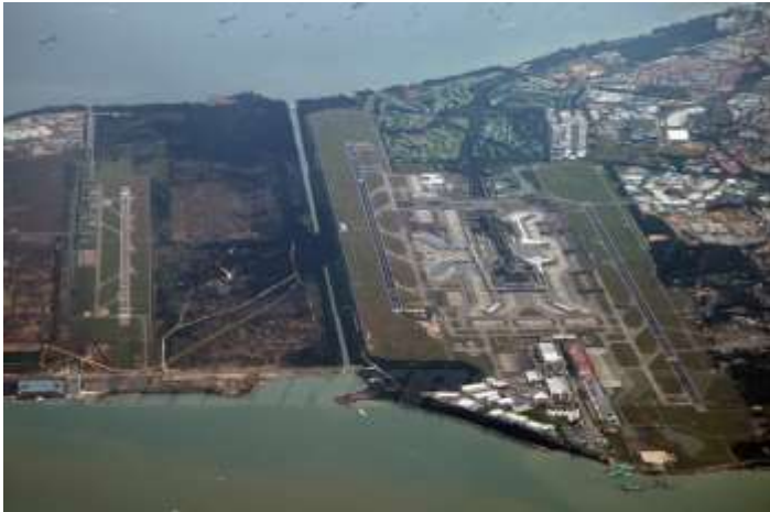
Gambar 2. 4 Parallel runway dengan threshold di geser
