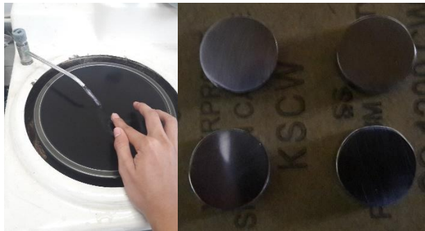
Gambar 3.2 Proses Pengamplasan Sampel Uji (kiri) dan Kondisi Sampel Uji setelah Pengamplasan (kanan)
