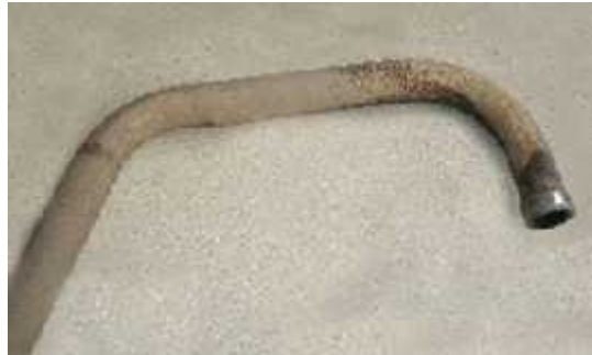
Gambar 2.15 Korosi pada knalpot kendaraan bermotor.
