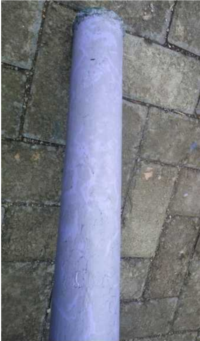
Gambar 4.8 Permukaan pipa coating primer dan sekunder setelah 28 hari
