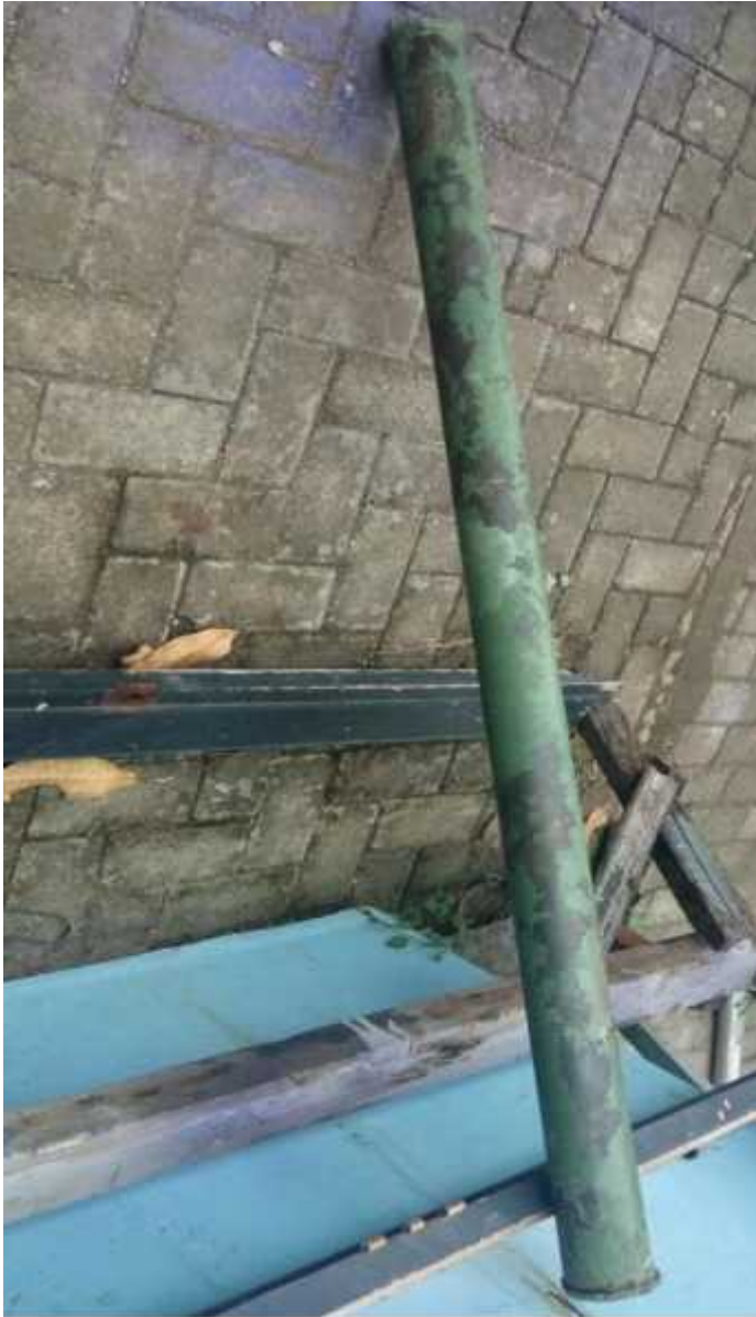
Gambar 4.5 Pipa dengan coating Primer setelah 28 hari pemberian arus proteksi
