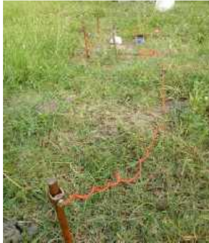
Gambar 3.6 Pengukuran Resistivitas Tanah
