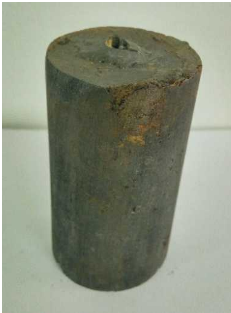
Gambar 4.11 Anoda grafit pada pipa coating primer
