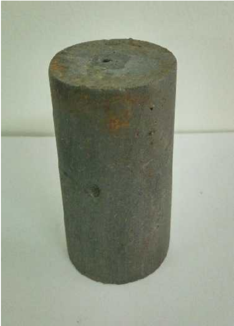
Gambar 4.12 Anoda grafit pada pipa coating primer dan sekunder
