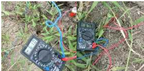
Gambar 4.4 Pengukuran potensial akhir pipa sebelum diberi arus proteksi
