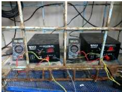
Gambar 3.19 Pemberian arus proteksi oleh rectifier
