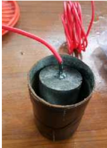
Gambar 3.15 Anoda yang akan diberikan backfill
