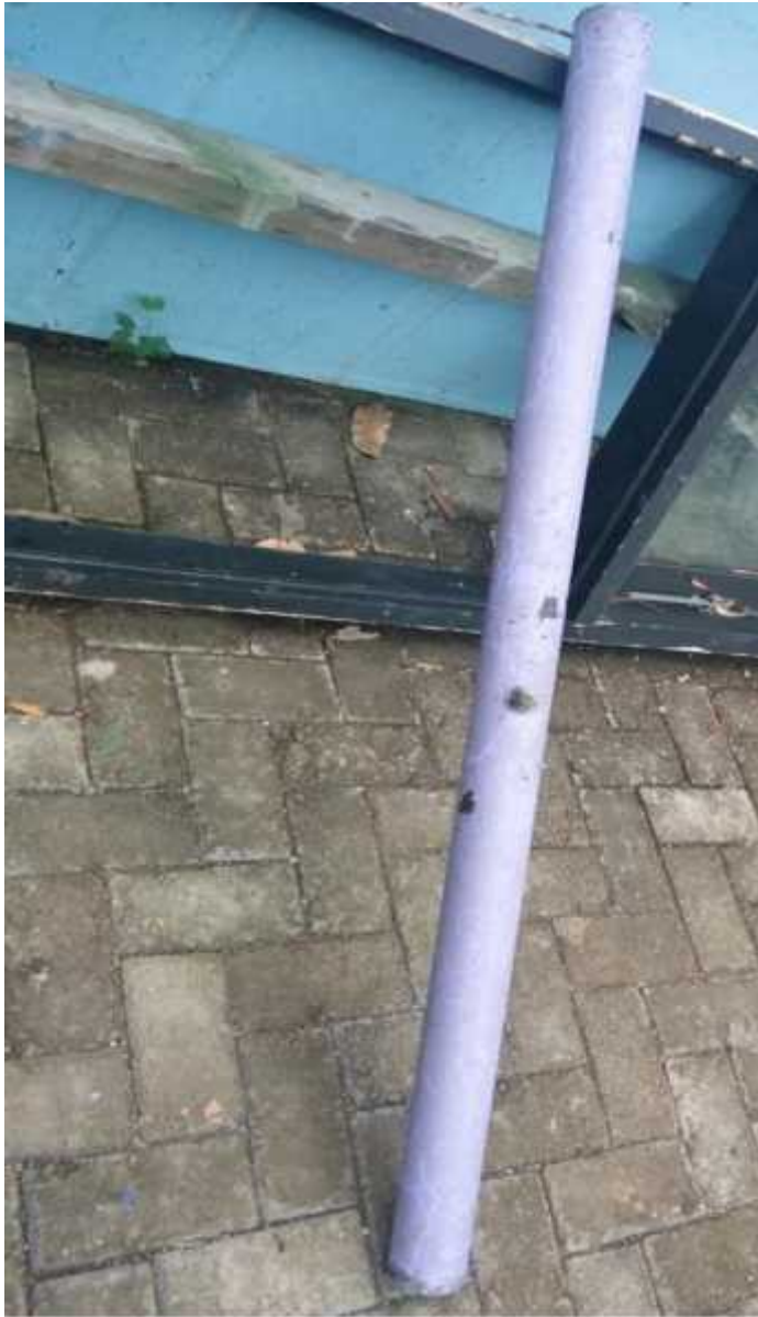
Gambar 4.6 Pipa dengan coating Primer dan Sekunder setelah 28 hari pemberian arus proteksi
