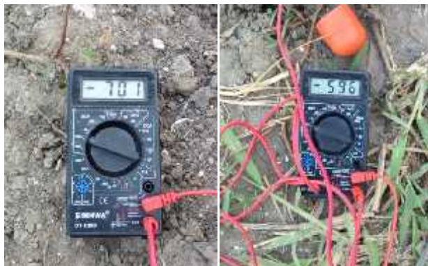
Gambar 4.1 Pengukuran potensial awal pipa sebelum diberi arus proteksi
