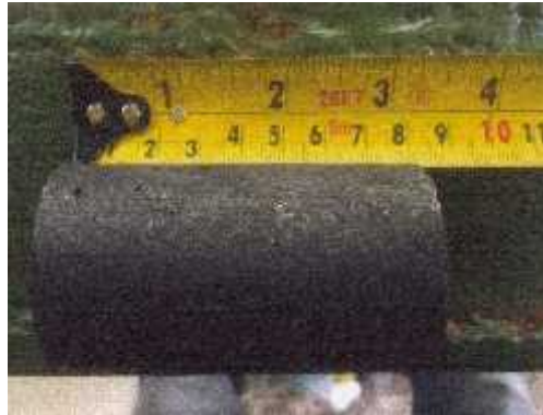
Gambar 3.13 Pengukuran anoda grafit
