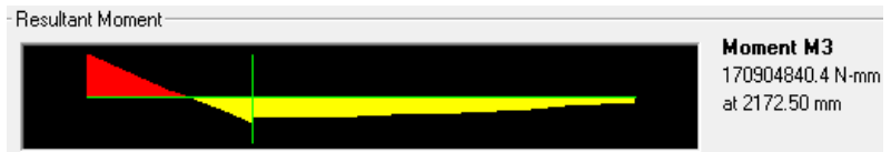
Gambar 4.2.4.4.2 Momen Lapangan Balok Balok Induk 40/60 Lantai 2
