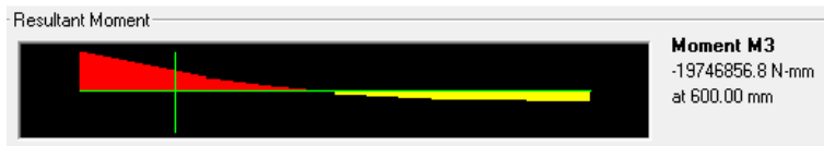
Gambar 4.2.4.5.2 Momen Lapangan Balok Induk 20/30 Lantai 2
