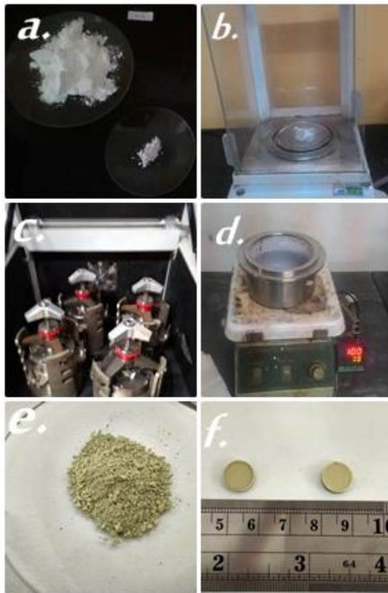
Gambar 4.1 a.) Serbuk ZnO dan \text{Al}_2\text{O}_3 , b). Penimbangan serbuk c.) Sintesis dengan metode mechanical milling . d.) Serbuk yang dipanaskan di hot plate , dan berwarna abu-abu e.)Serbuk yang telah di sintering dan berwarna kuning. f.)
