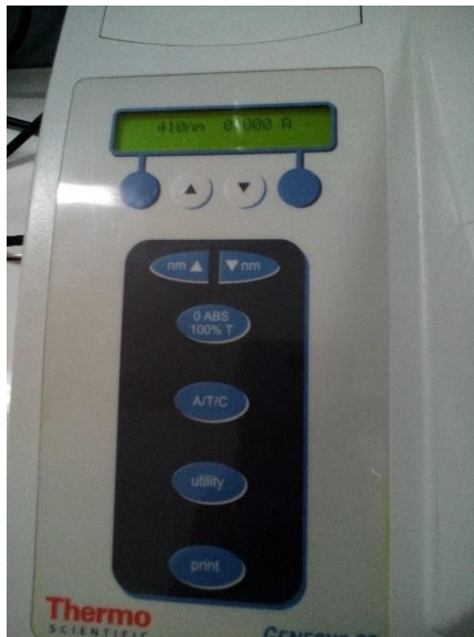
Gambar A.15 Spektrofotometer dengan panjang gelombang 410 untuk analisis nitrat
