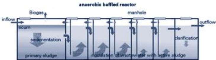
Gambar 2. 3 Contoh Penampang Membujur Unit ABR (Sumber: Sasse dKK., 2009)
