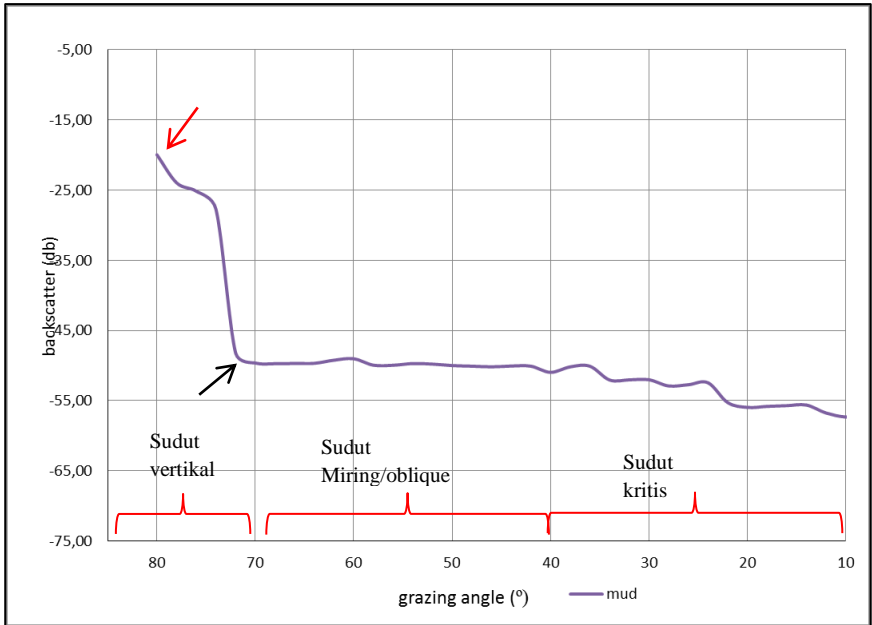
Gambar 4.24 Kurva Angular Response Curve pada sedimen mud
