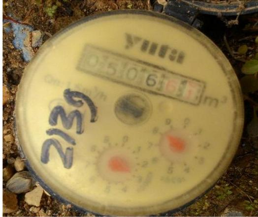
**Gambar 5. 5 Contoh Temuan Meter Air pada Rumah Tangga yang Tidak Menggunakan Pembacaan *Barcode***
