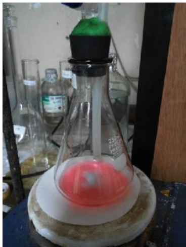
Gambar A.4 Perubahan Warna Larutan Titrasi Dengan Methyl Orange (MO)
