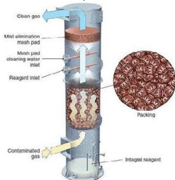
Gambar II.1 Kolom absorpsi konvensional dengan packing
