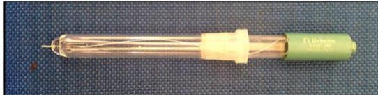
**Gambar 3.7** Elektrode Platina
