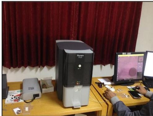
**Gambar 3.11** Alat Pengujian SEM
