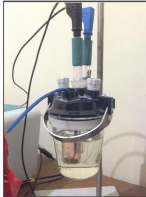
**Gambar 3.9** Rangkaian Pengujian Polarisasi Potensiodinamik
