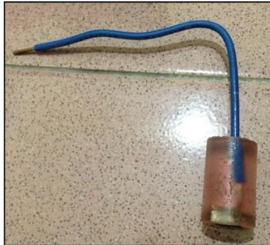
**Gambar 3.3** Spesimen Uji Polarisasi Potensiodinamik dan EIS
