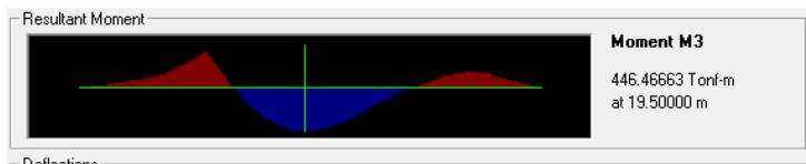
**Gambar 5. 24** Bidang Momen pada Dinding Secant Pile Wall
