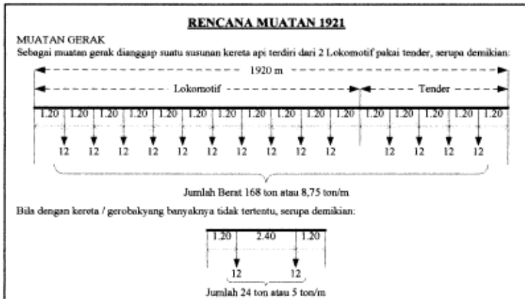
Gambar 4. 1 Beban Gandar yang Digunakan
