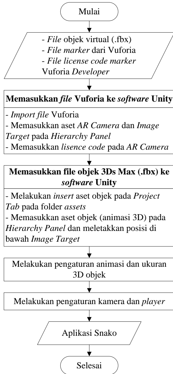
Gambar 4. 10 Alur Pembangunan Sistem di Software Unity
