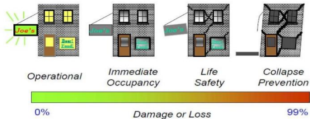
Gambar 2.1 Tingkat Kinerja Struktur Bangunan FEMA 356 Sumber FEMA 356,2000
