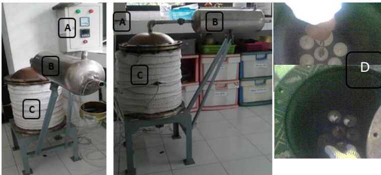
Gambar 3.2 Reaktor Pirólisis (A) Termocouple (B) Kondensor 40 cm (C) Tungku Pembakar (D) Reaktor Tampak Dalam
