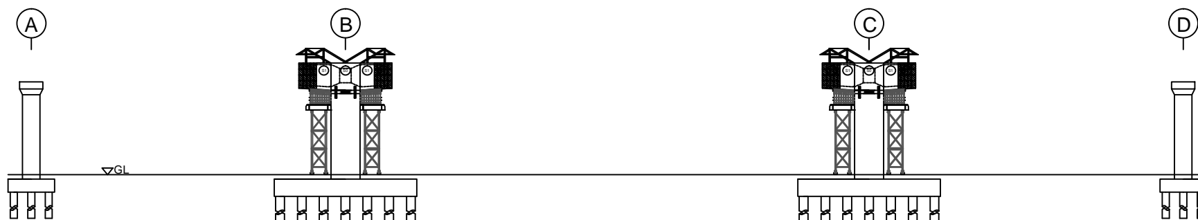
PEMASANGAN SEGMENT S2 SKALA 1 : 900
