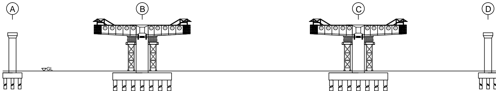
PEMASANGAN SEGMENT S6 SKALA 1 : 900
