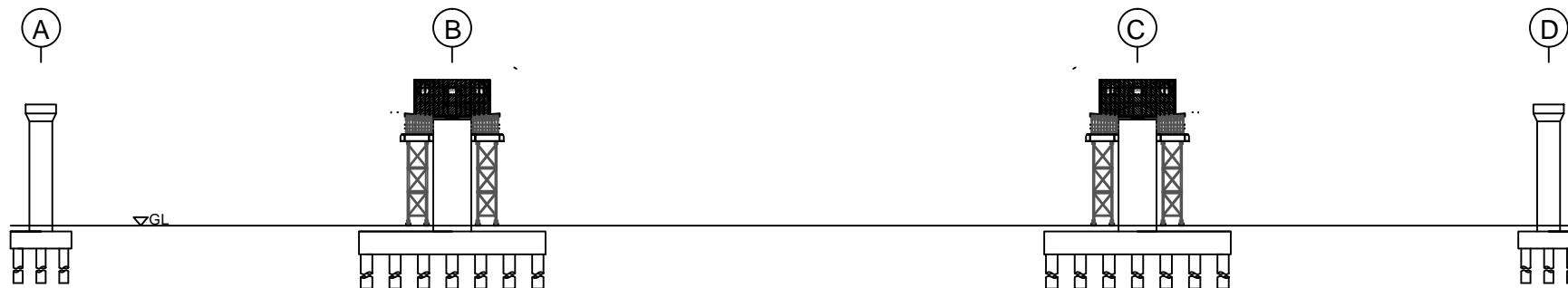
PEMASANGAN SEGMENT S0 DAN S1 SKALA 1 : 900
