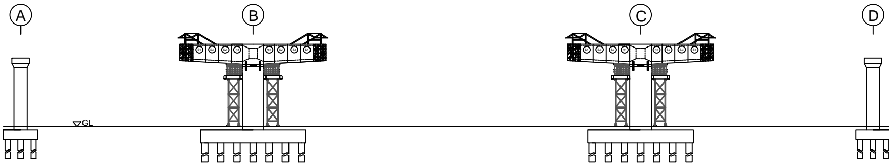
PEMASANGAN SEGMENT S5 SKALA 1 : 900
