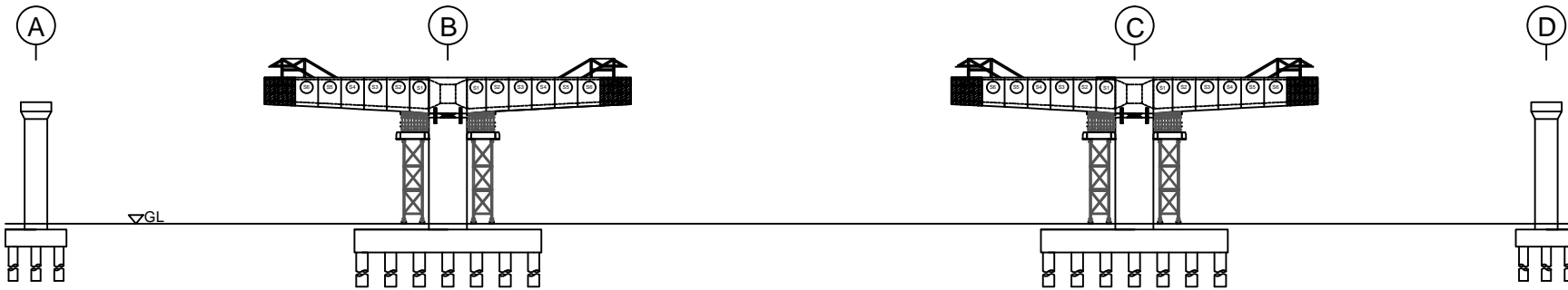
PEMASANGAN SEGMENT S7 SKALA 1 : 900
