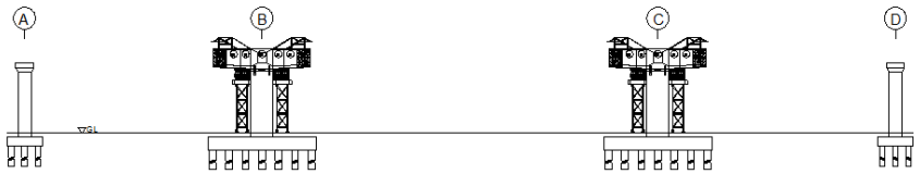
Gambar 4. 65 Pemasangan segmen S3
