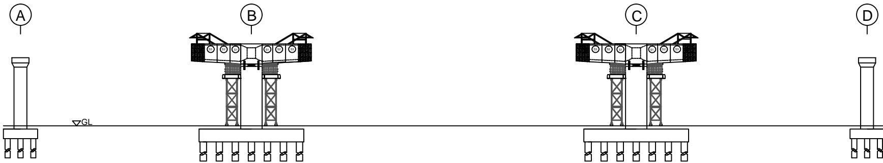
PEMASANGAN SEGMENT S4 SKALA 1 : 900
