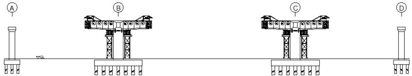
Gambar 4. 66 Pemasangan segmen S5
