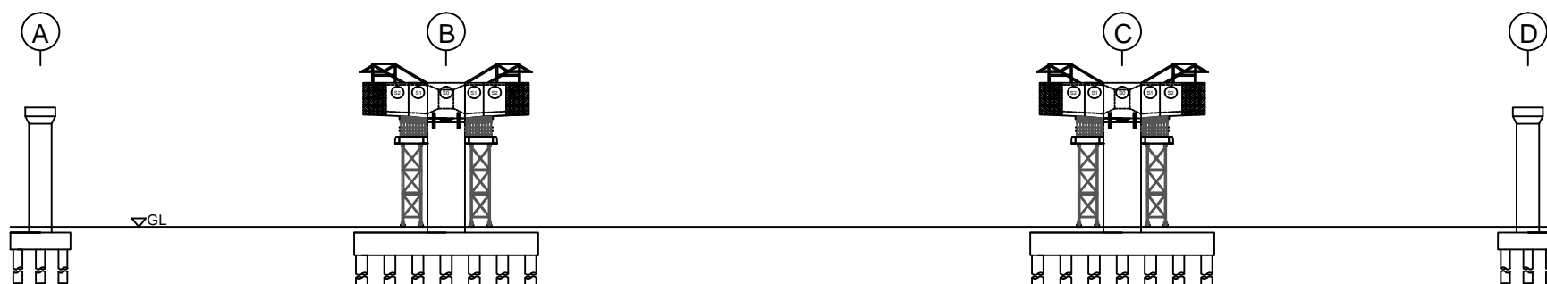
PEMASANGAN SEGMENT S3 SKALA 1 : 900
