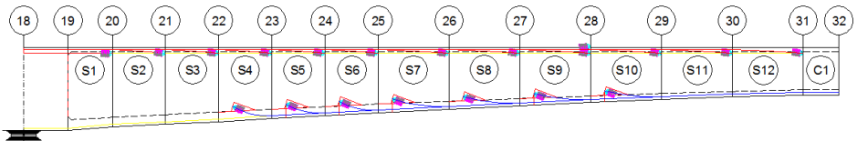
Gambar 4. 36 Layout tendon bawah
