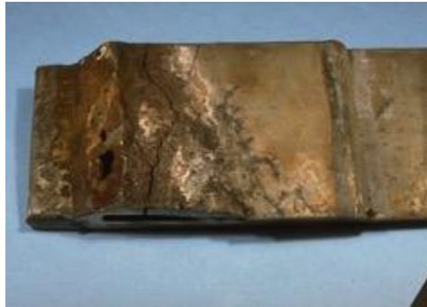
Gambar 2. 6 Korosi Retak Tegang ( Corrosionclinic , 2013)
