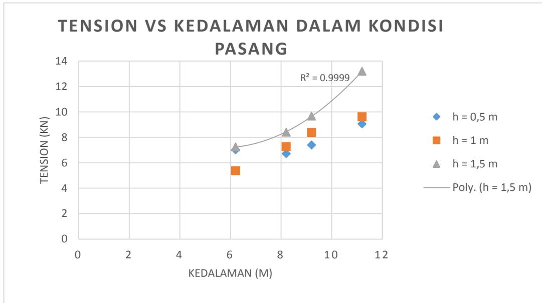
**Gambar 4. 17** Grafik hasil simulasi *tension* maksimum kondisi pasang
