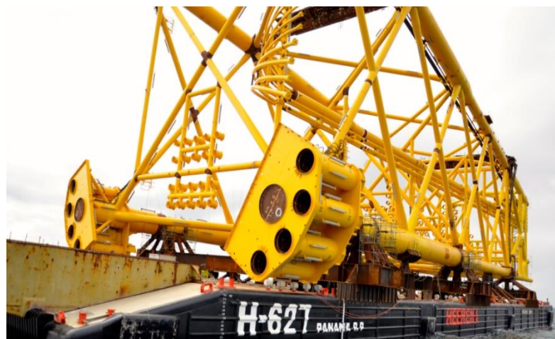
Gambar 2.2. Skirt Pile pada Jacket (HMC, 2017)
