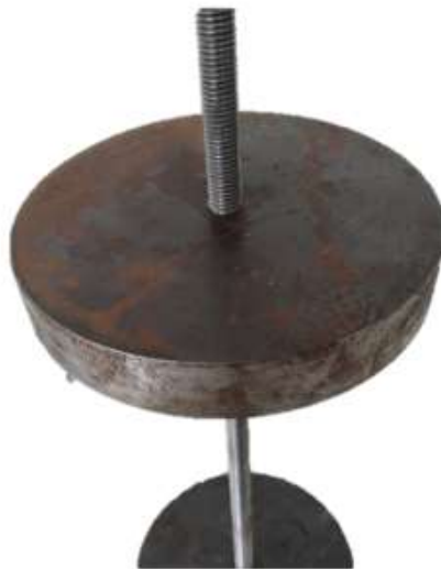
Gambar 4.6. Pemberat dan ulir di dalam lambung model fisik.
