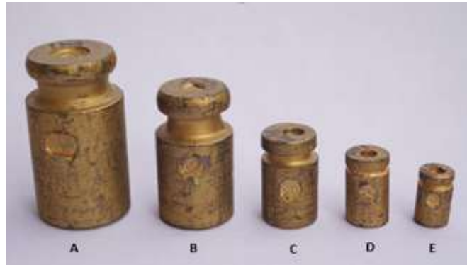
Gambar 4.31. Beban Kalibrasi 1000 g (A), 500 g (B), 200 g (C), 100 g (D) dan 50 g (E).
