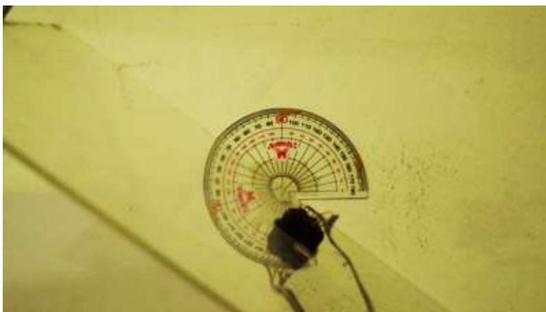
Gambar 4.18. Gyroscope dan geladak saat proses kalibrasi.
