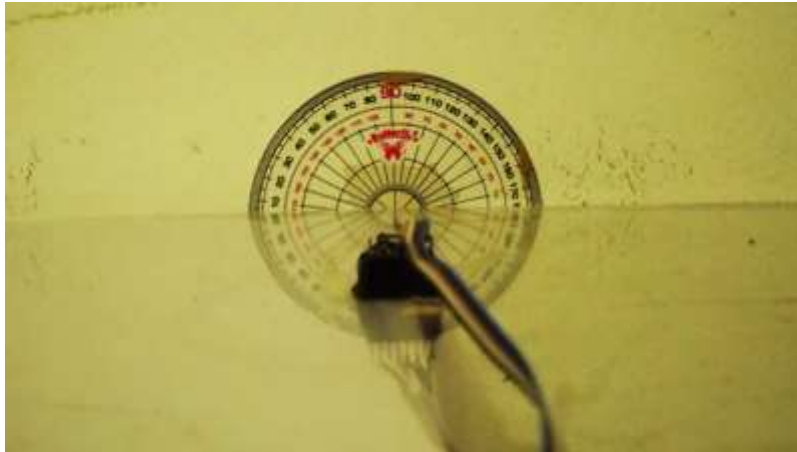
Gambar 4.16. Gyroscope pada geladak model fisik.
