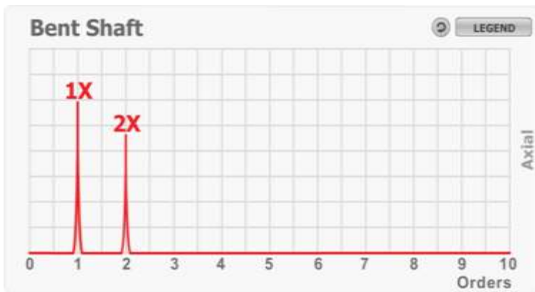
Gambar 2.27, Spektrum vibrasi pada poros bengkok (Mobius Institute, 2017).
