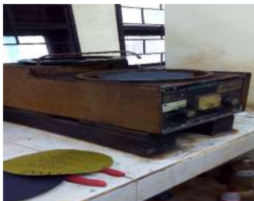
Gambar 3.30 alat untuk gerinding dan polishing
