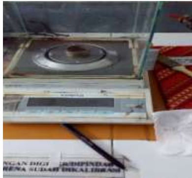
Gambar 3.42 Proses penimbangan berat material spesimen uji
