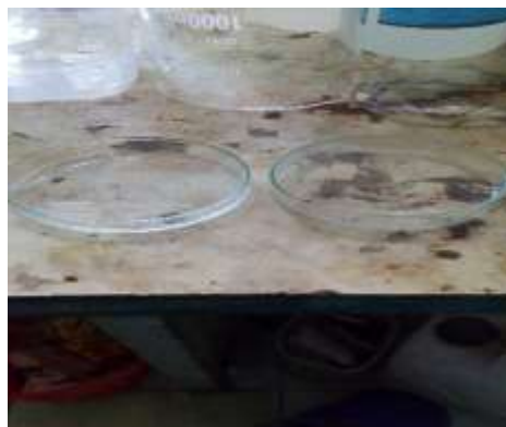
Gambar 3.15 Larutan Nital untuk uji etsa
