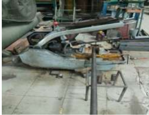
Gambar 3.21 Proses pemotongan material spesimen uji
