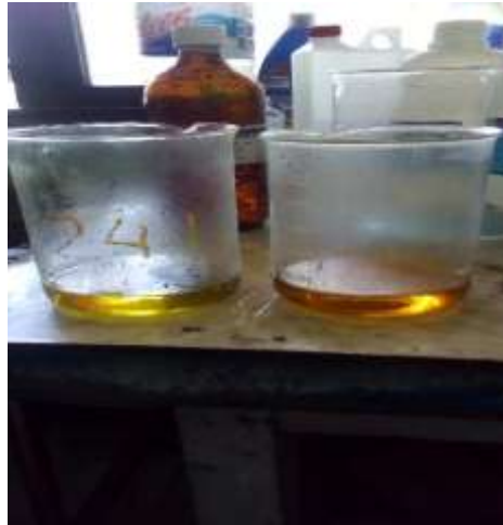
Gambar 3.16 Larutan HCL untuk proses pickling
