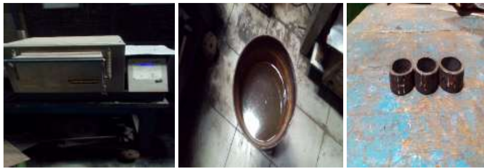
(i) (ii) (iii) Gambar 4.1 (i) Furnace, (ii) proses pendinginan pada air, (iii) material yang sudah di Hardening
