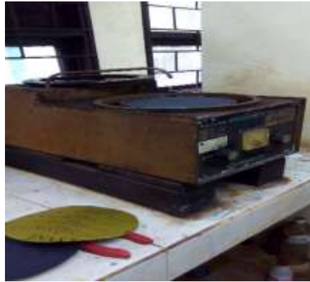
Gambar 3.5 Mesin Girinding atau Polishing
