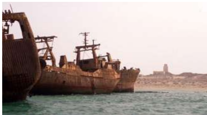
Gambar 2. 10 Korosi seragam pada lambung kapal
