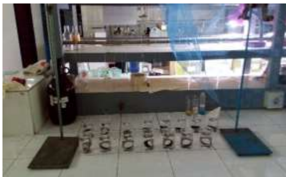
Gambar 3.11 Tiang penggantung spesimen uji
