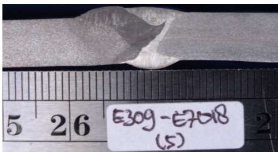
Gambar 4.20 Foto Makro Variasi Elektroda dan Weld Layer E309 dengan E7018
