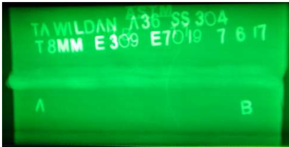
Gambar 4.6 Hasil Pengujian Radiografi Pengelasan SMAW Baja Karbon A36 dengan Stainless Steel SUS304 dengan Variasi Electrode dan Desain weld layer E309 dan E7018
