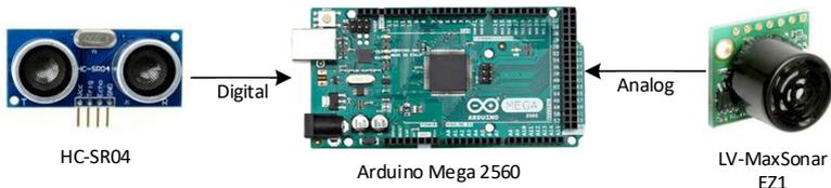
Gambar 3. 7 Perancangan *Wiring* sensor jarak dengan Arduino Mega 2560
