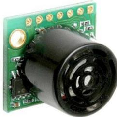
**Gambar 2.3** Sensor Ultrasonik LV-MaxSonar EZ
