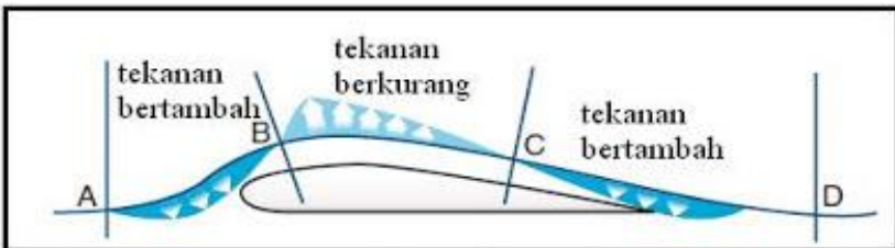
Gambar 2.8 Momentum Mempengaruhi Aliran Udara Pada Airfoil [10]
