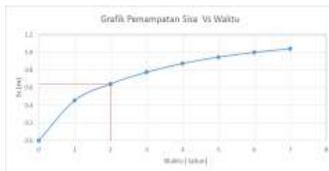
Gambar 5.8 Hubungan pemampatan sisa dengan waktu pemampatan sisa (sumber : hasil analisa)
