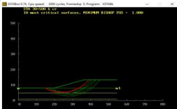
Gambar 5.6 Hasil analisis untuk mencari nilai H kritis dengan menggunakan program bantu XSTABL.
