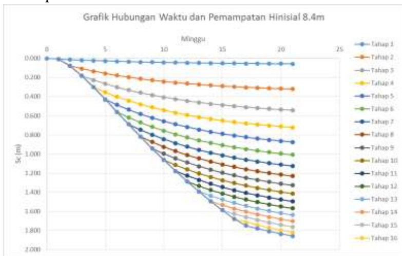
Gambar 5.7 Grafik Pemampatan Tanah akibat Penimbunan Bertahap (sumber : hasil analisa)
