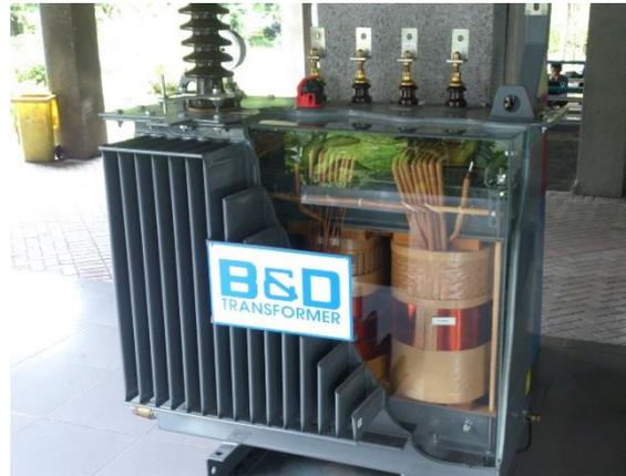
**Gambar 4.8** Foto *cut-away view* dari sebuah transformer distribusi
