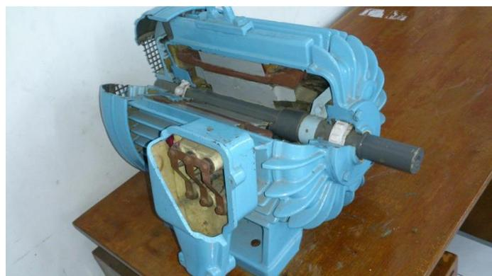
**Gambar 4.6** Bentuk terpotong dari generator sinkron.
