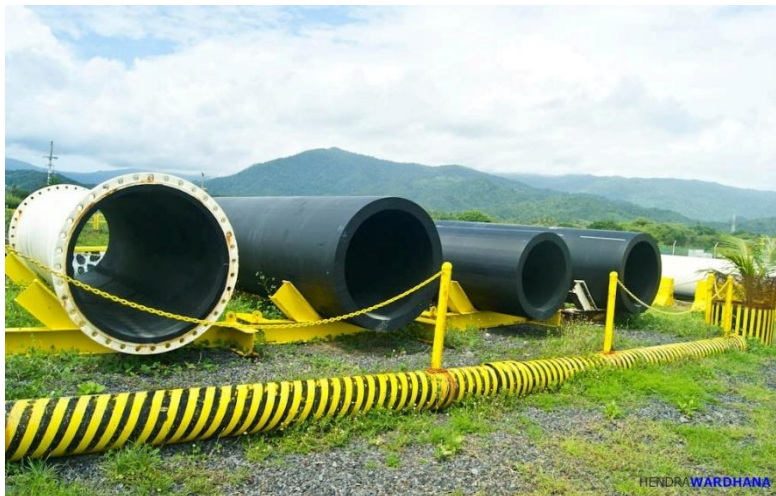
Gambar 2.6 Saluran Pipa HDPE (Sumber: Wardhana, H., 2016)
