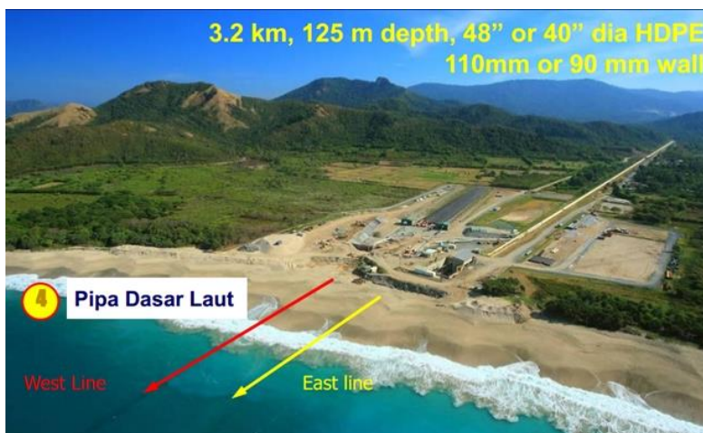
Gambar 2.3 Penggambaran Jalur Pipa Tailing di Teluk Senunu (Sumber: Newmont Nusa Tenggara, 2010)
