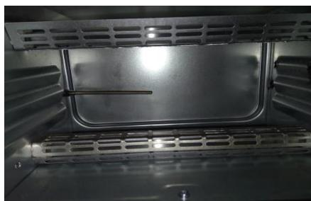
**Gambar 4.2** Foto Letak Sensor Termokopel Dibelakang dengan Probe 10 cm.
