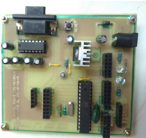
Gambar 3.12 Foto Minimum sistem ATmega 328 dan Max 232
