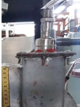
Gambar 3.7 Konfigurasi Sensor Level Switch
