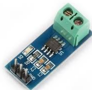
Gambar 2.9 Modul sensor ACS712 20A [5]
