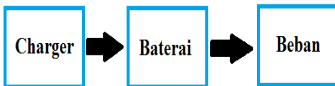
Gambar 2.5 Diagram suatu sistem tanpa menerapkan BMS [3]
