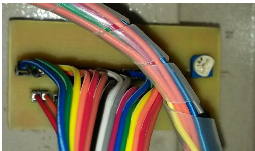
Gambar 3.27 Rangkaian LCD dan pengatur kontras
