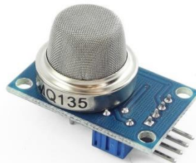
Gambar 2.3 Bentuk Fisik MQ-135
