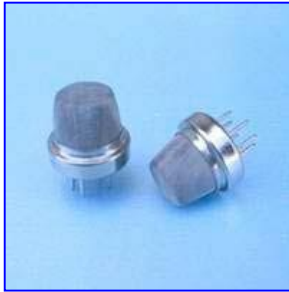
Gambar A.2 Bentuk Fisik Sensor MQ - 135
