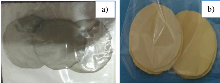
Gambar 4.5 Hasil preparasi membran a) P84/komposit karbon zeolit b) P84
