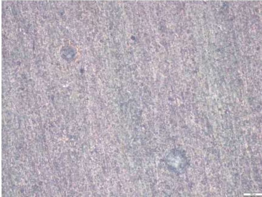
Gambar 4.17. Struktur Mikro permukaan alumunium 6063 yang dipengaruhi bakteri Pseudomonas putida pada salinitas 33 ‰, pembesaran 100 kali.
