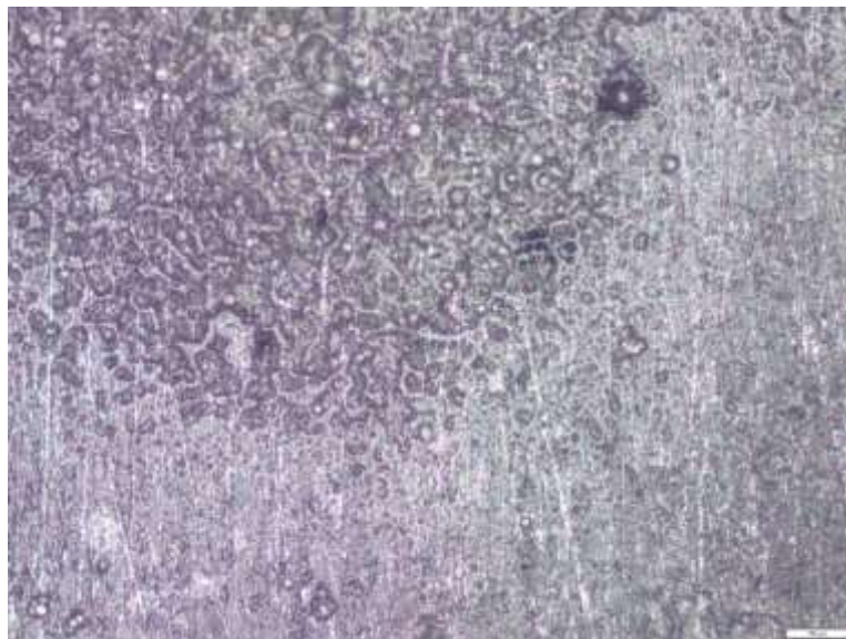
Gambar 4.12. Struktur Mikro permukaan alumunium 6063 yang dipengaruhi bakteri Azotobacter pada salinitas 35 ‰, pembesaran 100 kali.
