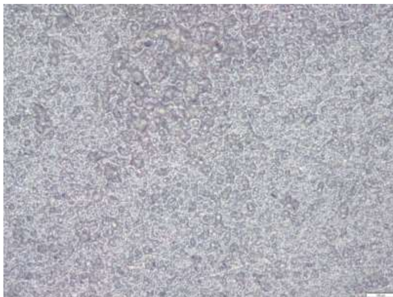
Gambar 4.18. Struktur Mikro permukaan alumunium 6063 yang dipengaruhi bakteri Pseudomonas putida pada salinitas 35 ‰, pembesaran 100 kali.
