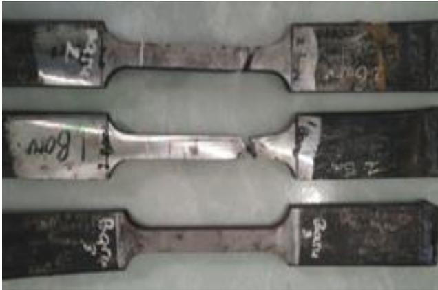
**Gambar 4.2** Spesimen Hasil Uji Tarik Pegas Daun Baru
