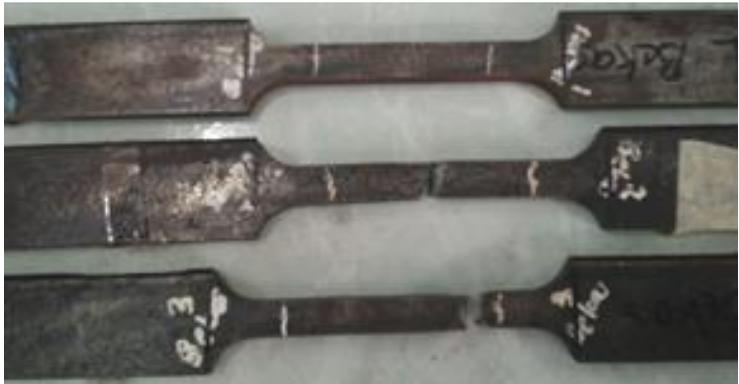
**Gambar 4.4** Spesimen Uji Tarik Sebelum *Quench-Temper*
