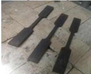
**Gambar 3.15** pendinginan Udara Setelah Proses *Tempering*
