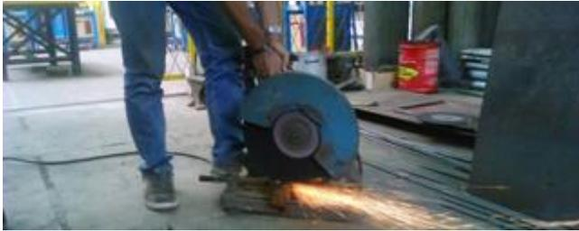
**Gambar 3.5** Proses Pemotongan Spesimen
