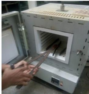
**Gambar 3.14** Pengambilan Spesimen dari Oven
