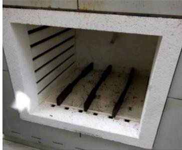
**Gambar 3.11** Pemasukan Spesimen ke Dalam Oven
