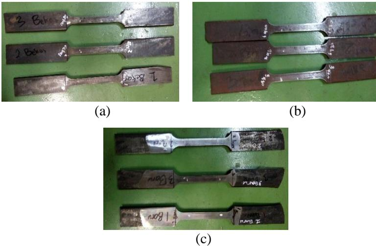
**Gambar 3.18** Spesimen Uji Tarik (a) Sebelum Proses Quench-Temper, (b) Spesimen Uji Tarik Setelah Proses Quench-Temper dan (c) Spesimen Uji Tarik Keadaan Baru
