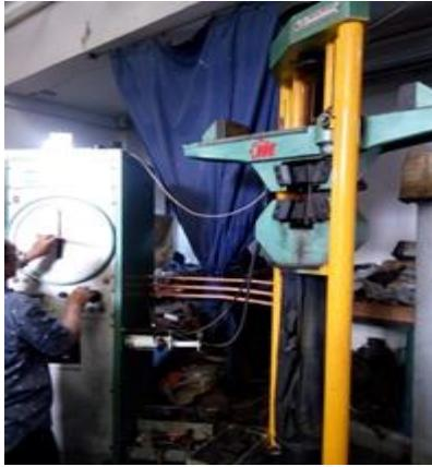
**Gambar 3.19** Mesin Uji Tarik
