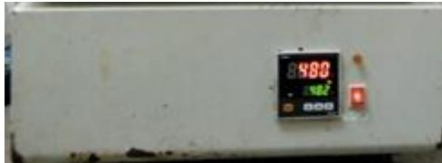
**Gambar 3.12** Proses Tempering dengan Temperatur 480°C
