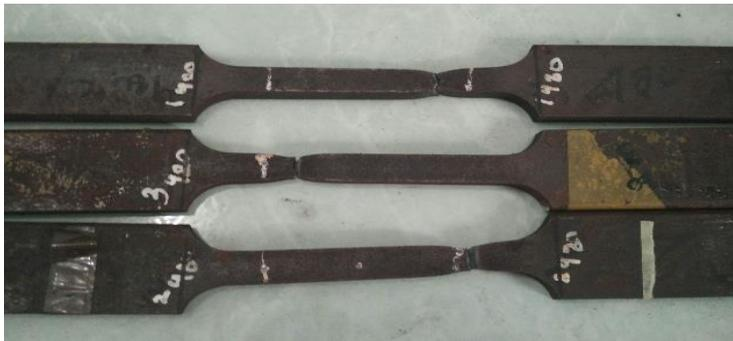
**Gambar 4.6** Spesimen Uji Tarik Setelah *Quench-Temper* dengan Temperatur 480°C
