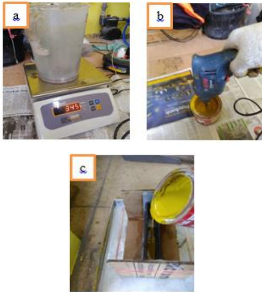
Gambar 3.8 Proses pembuatan core material , (a) Timbang berat Resin, (b) mixer bahan baku core material , (c) Pengecoran core material pada cetakan
