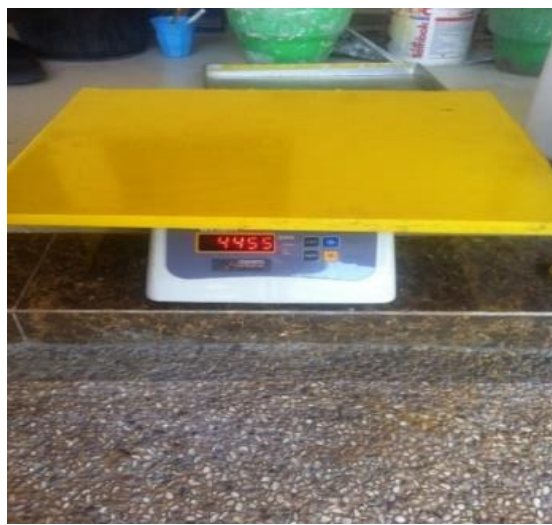
Gambar 3.2 Pengujian densitas core material
