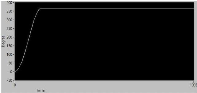
Gambar 8 Respon Perubahan Sudut *Joint Base* saat Diberi *Input* 360 Derajat dengan Nilai  $K_p$  1,  $T_i$  0,  $T_d$  0
