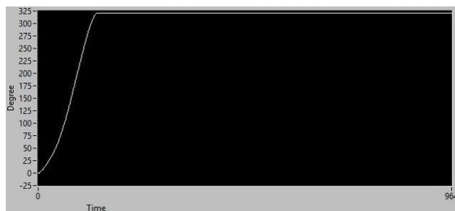
Gambar 7 Respon Perubahan Sudut *Joint Base* saat Diberi *Input* 315 Derajat dengan Nilai  $K_p$  1,  $T_i$  0,  $T_d$  0
