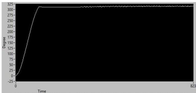
Gambar 3 Respon Perubahan Sudut *Joint Base* saat Diberi *Input* 315 Derajat dengan Nilai  $K_p$  2,  $T_i$  0,02,  $T_d$  0
