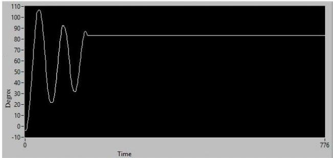
Gambar 26 Respon Perubahan Sudut *Joint Shoulder* saat Diberi *Input* 60 Derajat dengan Nilai  $K_p$  1,  $T_i$  0,  $T_d$  0
