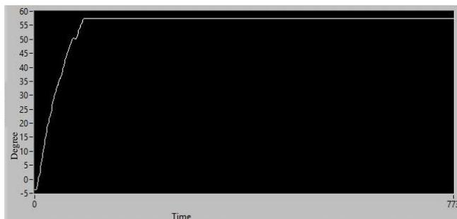
**Gambar 4.36** Respon Perubahan Sudut *Joint Shoulder* saat Diberi *Input* 60 Derajat dengan Nilai  $K_p$  1,  $T_i$  0,02,  $T_d$  0,008
