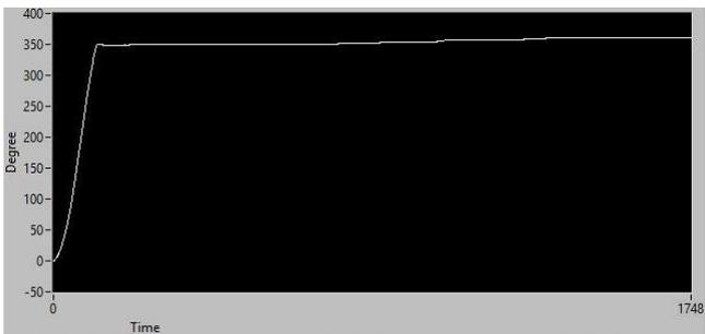
Gambar 4 Respon Perubahan Sudut *Joint Base* saat Diberi *Input* 360 Derajat dengan Nilai  $K_p$  2,  $T_i$  0,02,  $T_d$  0
