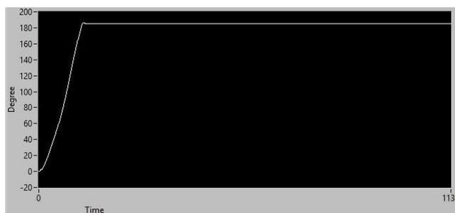
Gambar 6 Respon Perubahan Sudut *Joint Base* saat Diberi *Input* 180 Derajat dengan Nilai  $K_p$  1,  $T_i$  0,  $T_d$  0
