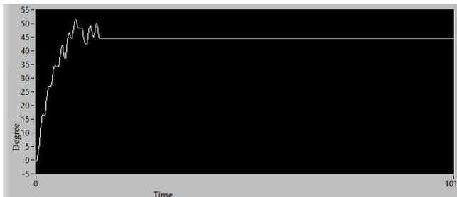
**Gambar 4.19** Respon Perubahan Sudut *Joint Base* saat Diberi *Input* 45 Derajat dengan Nilai  $K_p$  1,  $T_i$  0,09,  $T_d$  0,005
