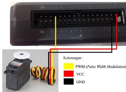
**Gambar 3.19** *Wiring* Motor Servo dan NI myRIO
