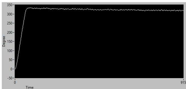
Gambar 19 Respon Perubahan Sudut *Joint Base* saat Diberi *Input* 315 Derajat dengan Nilai  $K_p$  1,  $T_i$  0,09,  $T_d$  0,001
