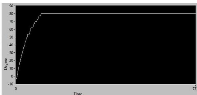
**Gambar 4.37** Respon Perubahan Sudut *Joint Shoulder* saat Diberi *Input* 80 Derajat dengan Nilai  $K_p$  1,  $T_i$  0,02,  $T_d$  0,008
