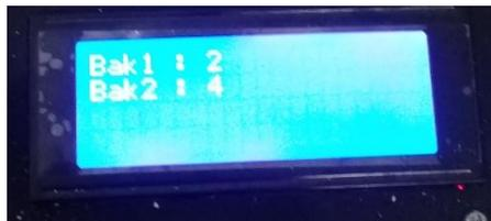
**Gambar 4.7** a) Kondisi Bak 1 dan 2 Terisi Sesuai *Set Point*, b) Tampilan pada LCD
