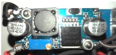
**Gambar 2.16** Bentuk Fisik Modul *Step Down* LM2596
