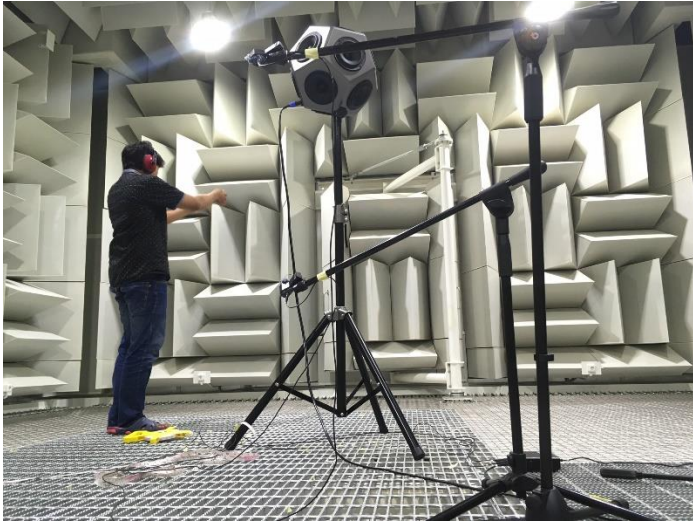
Pengukuran titik-titik koordinat letak mikrofon
