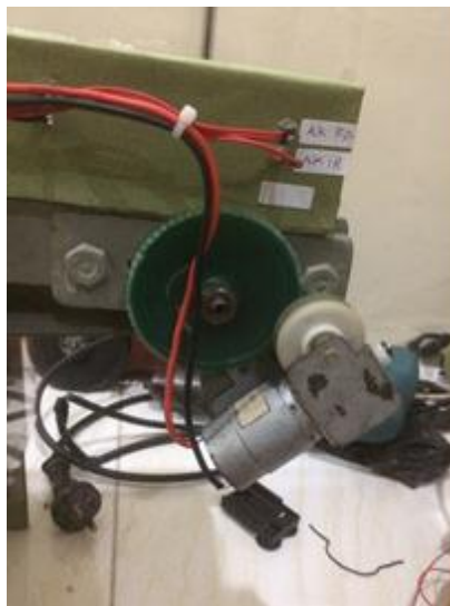
Gambar 4.6 Motor DC Sebagai Penggerak Konveyor
