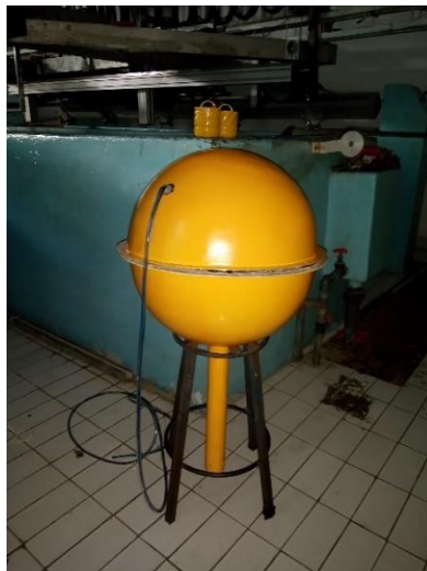
Gambar 3. 6 Wahana Apung Pengukur Tinggi Gelombang
