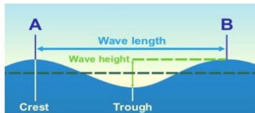
Gambar 3. 9 Definisi tinggi dan panjang gelombang laut (Kurniawan, 2012)
